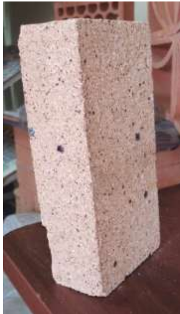
Figura 17. Ladrillo refractario K32 (segunda capa).
