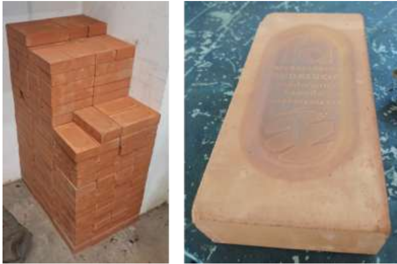
Figura 16. Ladrillo refractario M-25 (primera capa).
