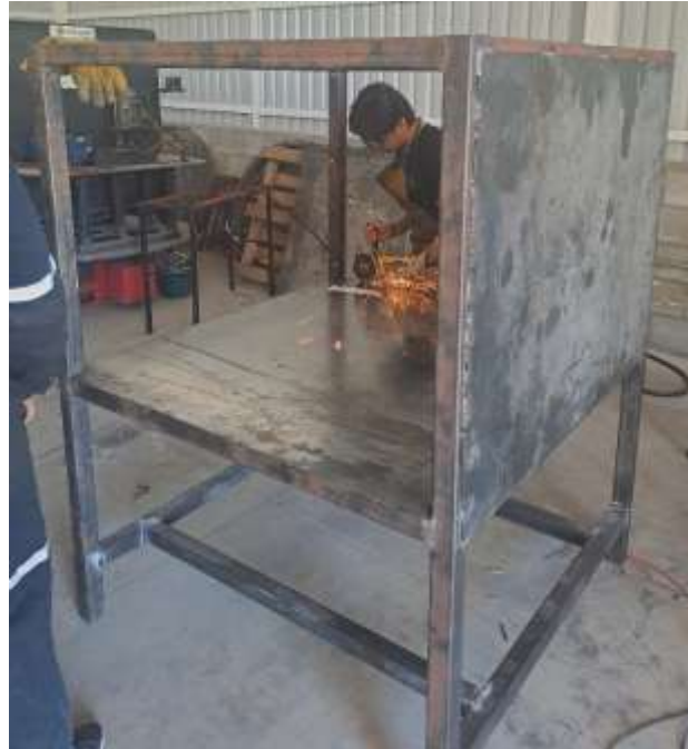
Figura 26. Esmerilado de puntos de soldadura del módulo de recubrimiento externo de seguridad.
