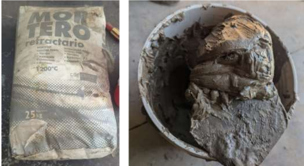
Figura 18. Saco de mortero (izq.) y preparación de la pasta refractaria con agua (der.).
