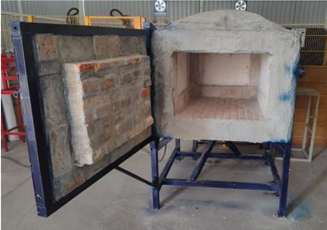
Figura 52. Vista completa del interior horno de tratamiento térmico concluido.
