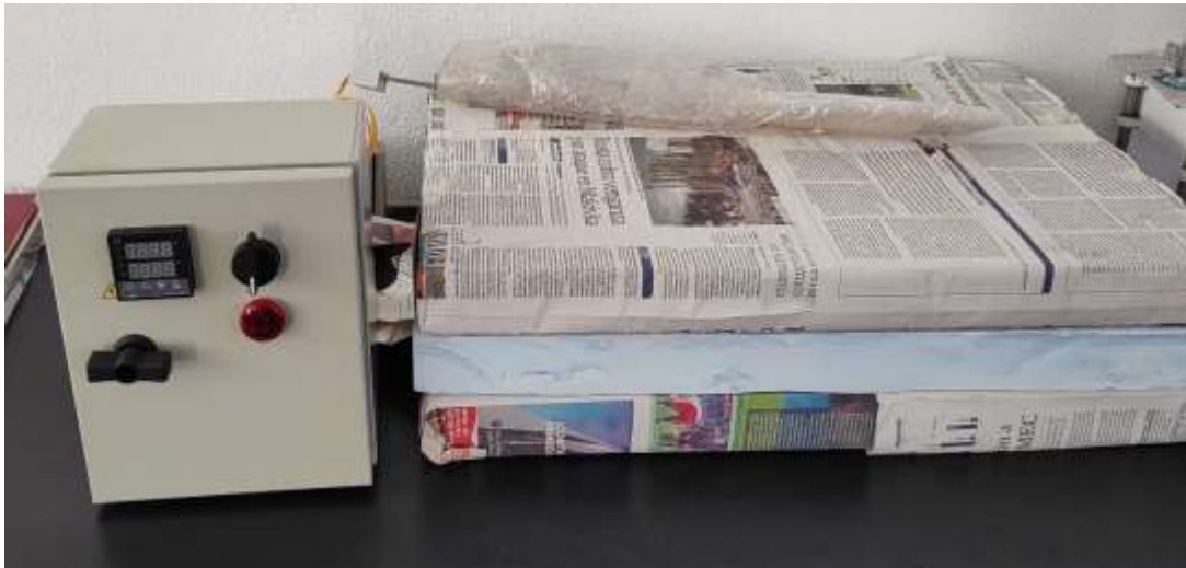
Figura 19. Conjunto de placas de fibra cerámica con resistencias eléctricas y gabinete de termopar sensor alámbrico.
