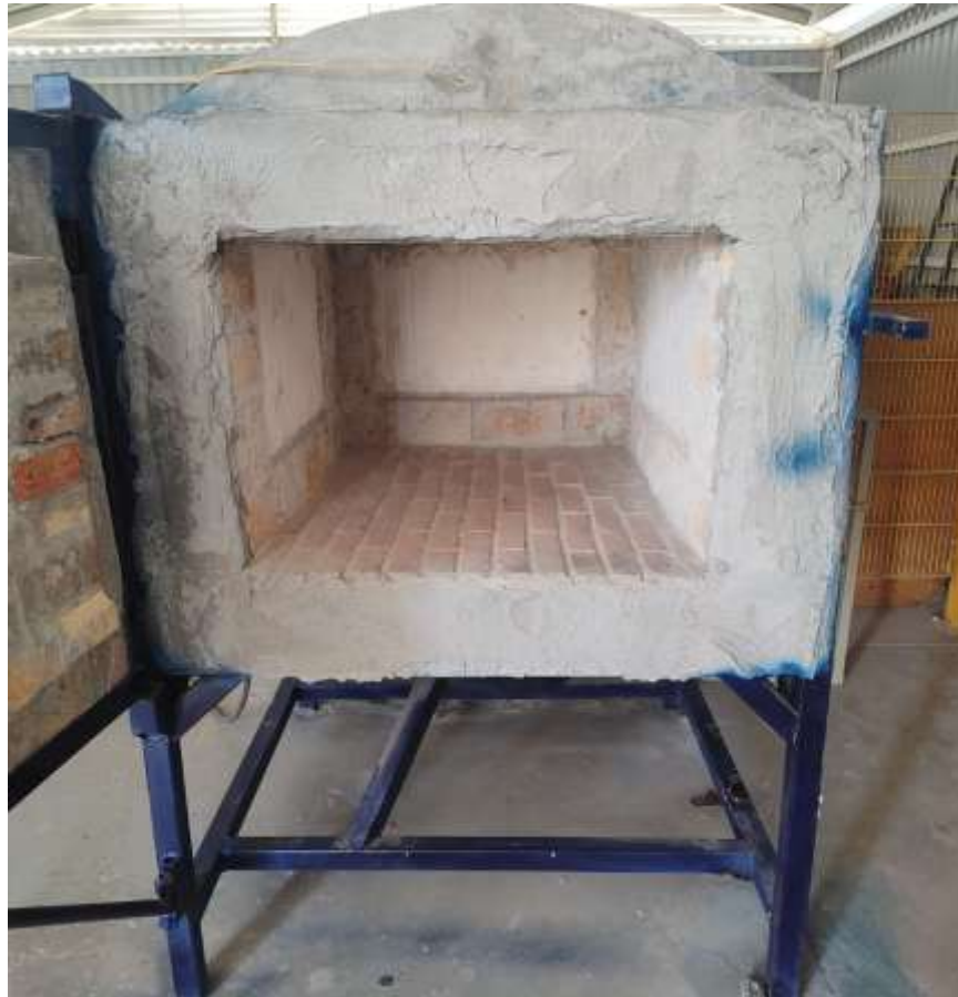
Figura 51. Vista de la cámara térmica del horno de tratamiento térmico concluido.
