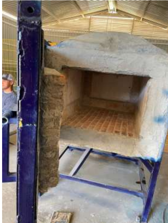
Figura 47. Sello de la puerta para ajuste de cierre hermético del equipo.
